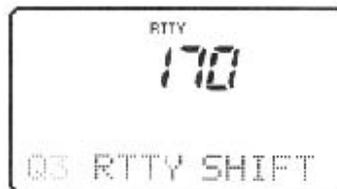
Разнос частот для RTTY установлен 170 Гц.
