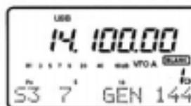
Дисплей отображает, что кнопке [F-2] теперь соответствует диапазон общего перекрытия приемника вместо значения по умолчанию 144 МГц.
