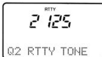
Частота логической единицы RTTY установлена 2125 Гц.
