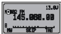
Пропуск канала включен
