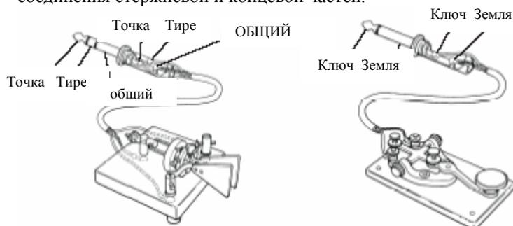
Примечание: Даже при использовании прямого ключа, Вы должны использовать трехконтактный ("стерео") разъем. Если используется двухконтактный разъем, то основной контакт будет замкнут на землю.
