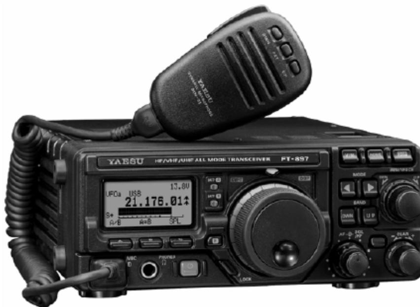
**FT-897** – это прочный, новаторский, многодиапазонный, многорежимный портативный трансивер для работы на радиоловительских MF/HF/VHF/UHF диапазонах. Покрывая 160-10 метровые диапазоны, а также 6, 2 метровые и 70 сантиметровые диапазоны, **FT-897** включает возможность работы в SSB, CW, AM, FM и цифровых режимах, предоставляя наиболее полный комплект технических возможностей для осуществления радиоловительской связи.
