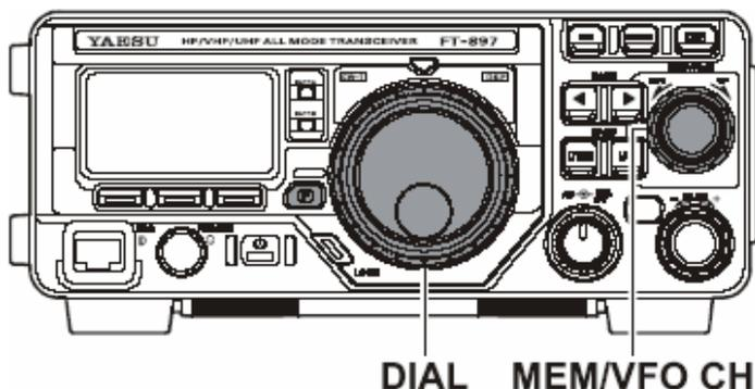
Шаг синтезатора для ручки **MEM/VFO CH** может быть установлен независимо для каждого вида модуляции. Используйте меню No-006 [AM STEP] для AM, No-052 [FM STEP] для FM и No-082 [SSB STEP] для SSB/CW/Цифровых режимов. Более подробно смотри на страницах 54, 57 и 59.
