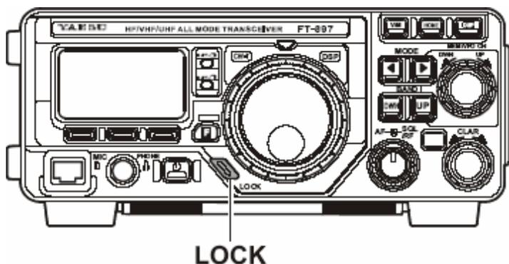
При работе с настройкой трансивера по умолчанию, нажатие кнопки блокировки (**LOCK**) отключает только ручку набора **DIAL**, тогда как остальные клавиши и выключатели продолжают работать.
