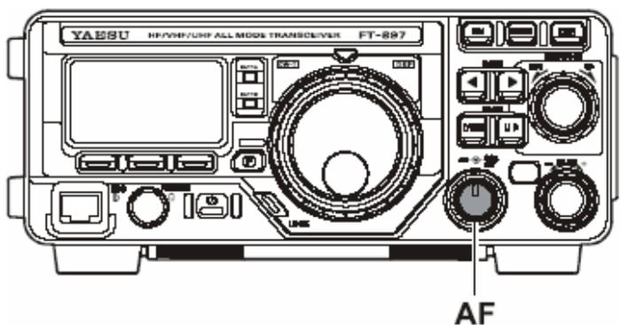
При работе с "DIG" или "PKT" модуляцией Вы можете установить ручку AF в любое удобное положение, ли даже полностью ее закрутить, поскольку на выходе штекера DATA будет аудиосигнал с фиксированным уровнем мощности.
