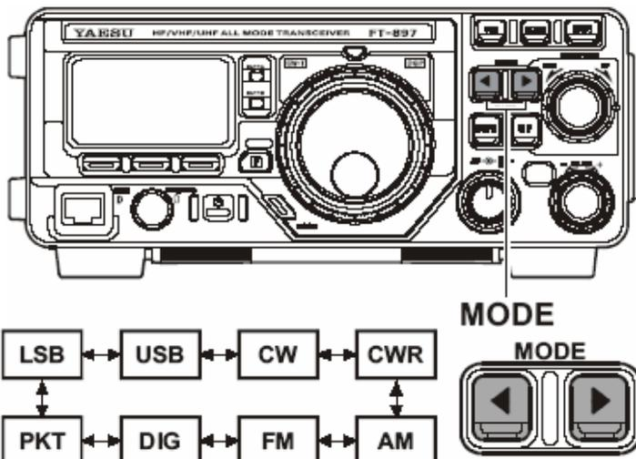
где "CWR" это "CW-Reverse" ("Обратный телеграф"), использующий боковую, противоположную используемой "по умолчанию" передающей боковой генератора частоты биений (в большинстве случаев используемой по умолчанию передающей боковой является "USB"). "DIG" – это основанный на AFSK цифровой режим, устанавливаемый в меню No-038 [DIG MODE]. "PKT" означает FM пакетную связь либо 1200 либо 9600 bps.
