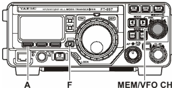
Теперь нажмите клавишу [A] (A/B) для переключения между VFO "A" и VFO "B". Для каждого любительского диапазона существует два VFO и, если Вы пожелаете, Вы можете установить VFO-A на диапазон с CW модуляцией, а VFO-B – на диапазон с SSB модуляцией. Вид модуляции будет сохранен вместе с частотой для каждого VFO.
