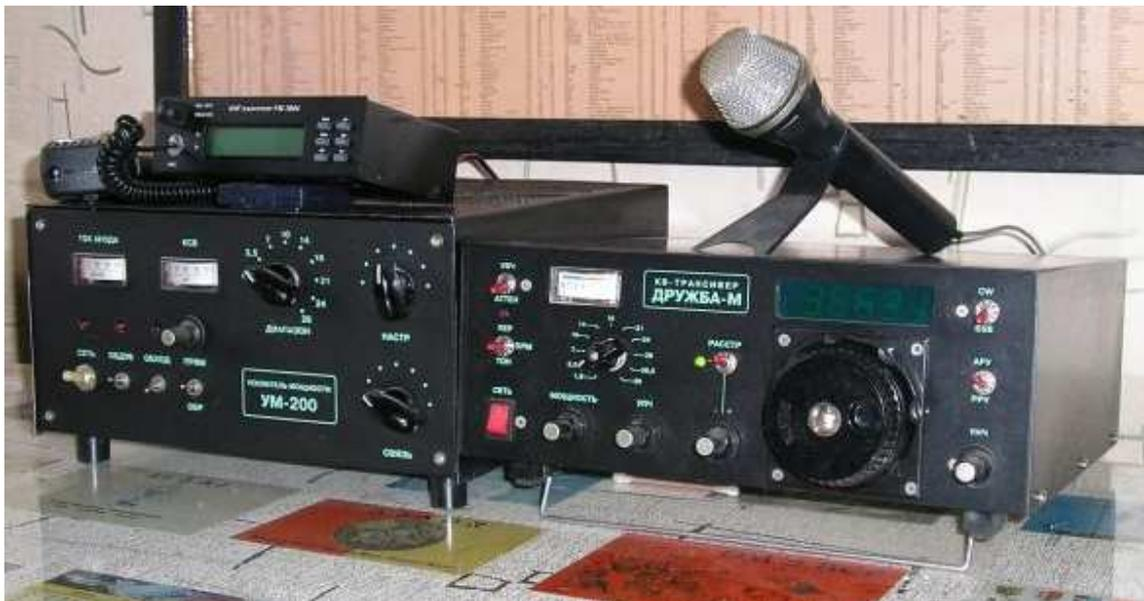
**Рис.2.5. Трансивер «Дружба-М» и усилитель мощности «УМ-200»**
